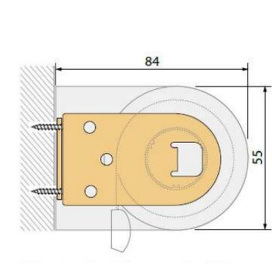
(wird optional für Rollos mit großer Höhe und großen Stoffdicken eingesetzt)
